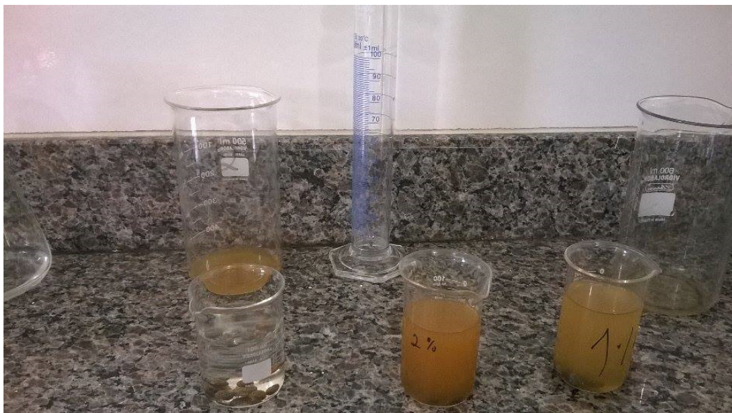
Figura 2- Preparação das soluções de 1% e 2% do extrato da casca da Geissospermum vellosii
