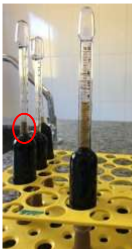
Figura 1. Resultado do teor de gordura obtido pelo método de Gerber para a amostra 1 de 1,1%.
