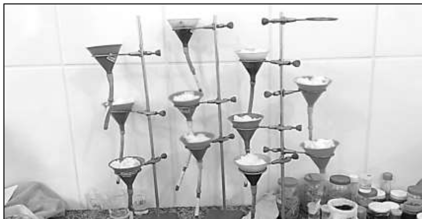
FIGURA 4. Extração das larvas do parasito utilizando o método de Baermann e Moraes.
