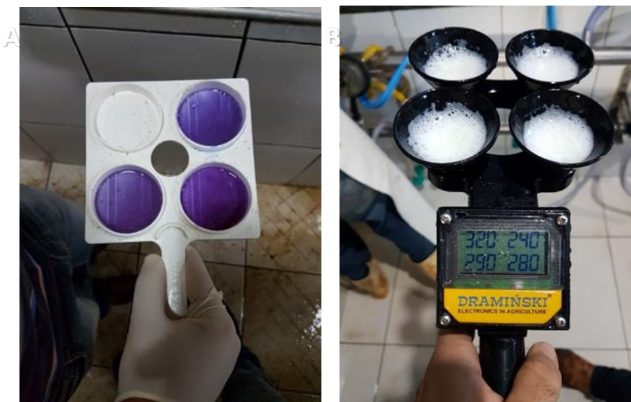
Figura 1: Imagem dos testes para detecção da mastite subclínica. A – California Mastitis Test B – Avaliação com o aparelho 4X4QMAST
