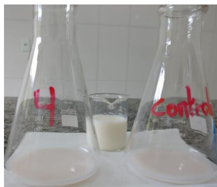
Figura 2: Amostra que atingiu o ponto de viragem comparada ao controle.
