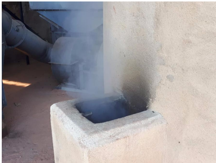
Figura 4: Vazão da fumaça quando não há água dentro do sistema de tratamento da fumaça. Fonte: Elaborado pelos autores (2018).
