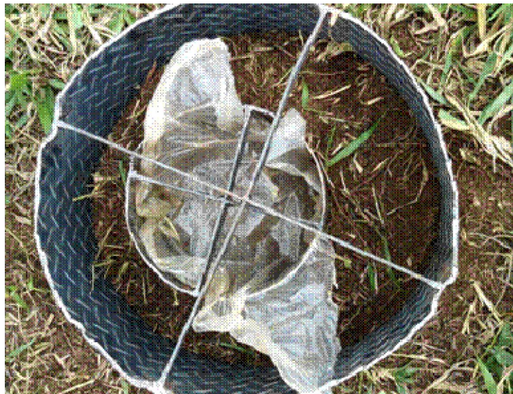
Figura 3 - Infiltrômetro de duplo anel, em chapa de aço com diâmetro de 50 cm anel externo e 25 cm anel interno, cravados no solo na Fazenda Boa Esperança em São João de Manhuaçu a 15 cm de profundidade.
