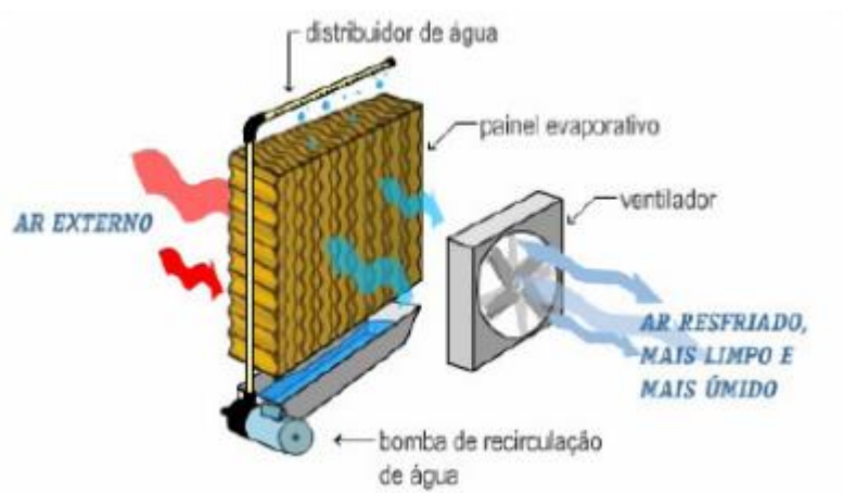
Figura 3: Esquema de Funcionamento do Resfriador Evaporativo.
