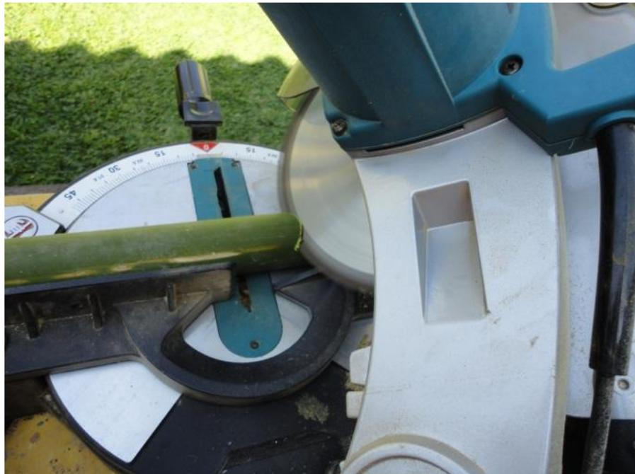
**Figura 19** - Cesura de 45° nos colmos existentes em cada vara de bambu. Criciúma – SC. 2012.
