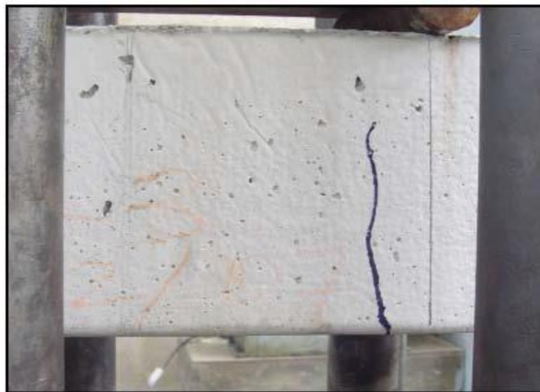
**Figura 38** - Abertura da 1ª fissura com abertura inferior a 0,2 mm. Maceió – AL. 2007. Fonte: Elaborado por (SILVA, 2007)
