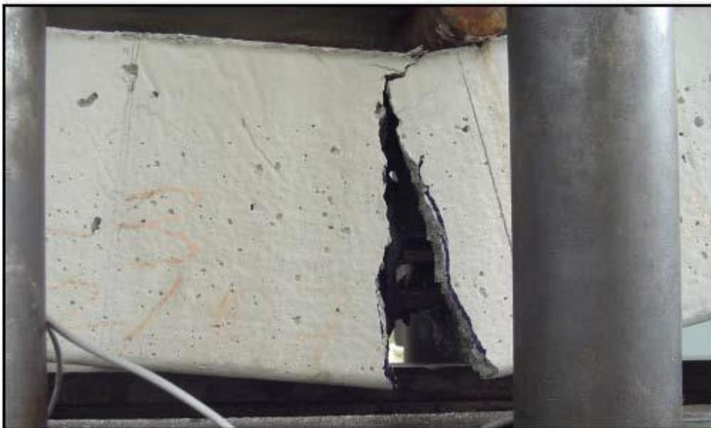
**Figura 40** - Destruição completa da viga para verificação da posição do reforço. Maceió – AL. 2007. Fonte: Elaborado por (SILVA, 2007)
