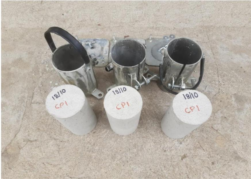
**Figura 14: Identificação dos corpos de provas desmoldados.**
