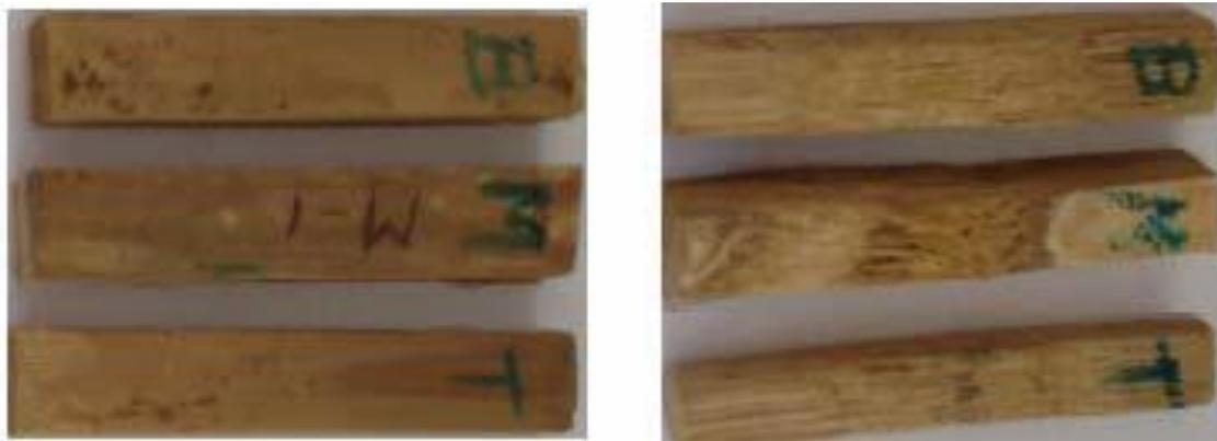
**Figura 27** - Amostras para o ensaio de determinação do teor de umidade e densidade. Maceió – AL. 2007. Fonte: Elaborado por (SILVA, 2007).
