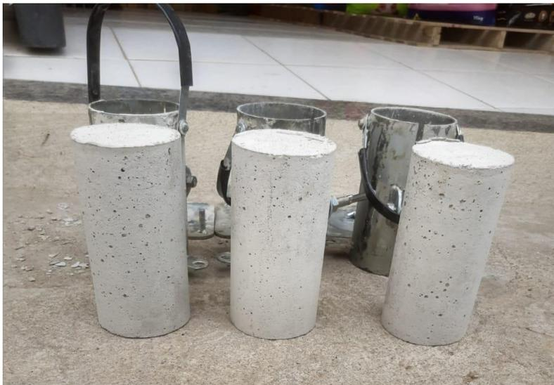
**Figura 13:** Corpos de provas desmoldados.
