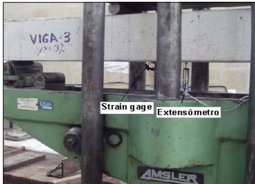
**Figura 37** - Viga instrumentada para o ensaio à flexão pura. Maceió – AL. 2007. Fonte: Elaborado por (SILVA, 2007)
