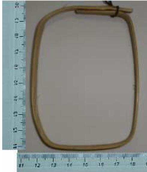
**Figura 32** - Detalhe do estribo de bambu de 6 cm x 9 cm, usados nas vigas 1, 2, 3 e 3.1. Maceió – AL. 2007. Fonte: Elaborado por (SILVA, 2007).
