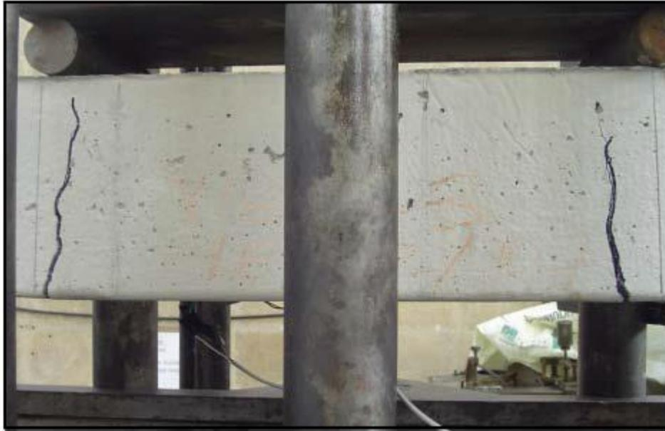
**Figura 39** - Abertura da 2ª fissura - abertura aproximada de 0,4 mm. Carga de Ruptura. Maceió – AL. 2007. Fonte: Elaborado por (SILVA, 2007)
