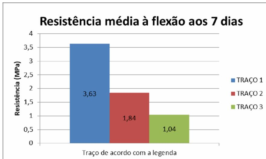
**Gráfico 4: Resistência média à flexão aos 7 dias de cura do concreto.**
