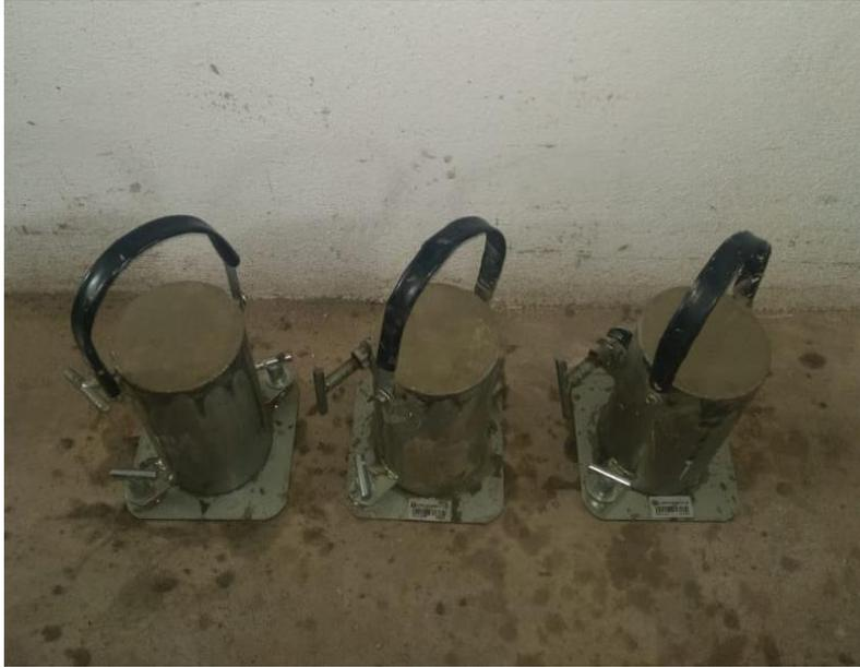
**Figura 12:** Moldagem nos corpos de provas revestidos internamente com óleo mineral.
