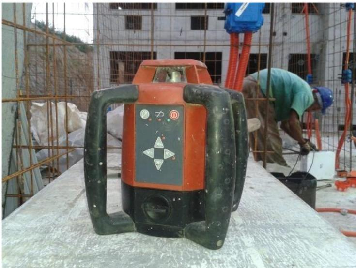
Figura 15 - Aparelho nivelador a laser - Fonte: (ACERVO PESSOAL, 2017)
