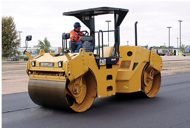
Figura 5: Rolo Compactador Vibratório Tandem.
