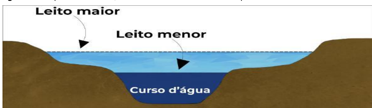
Figura 3 – Esquema de um rio, com o seu leito maior e menor representados.
