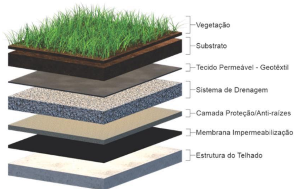
Figura 7 – Estrutura do telhado verde. Fonte: ECO TECNOLOGIAS (2021).
