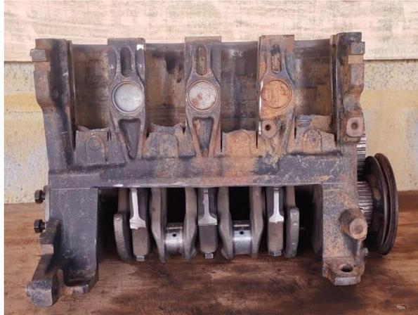
**Figura 18:** Bloco do motor após o corte
