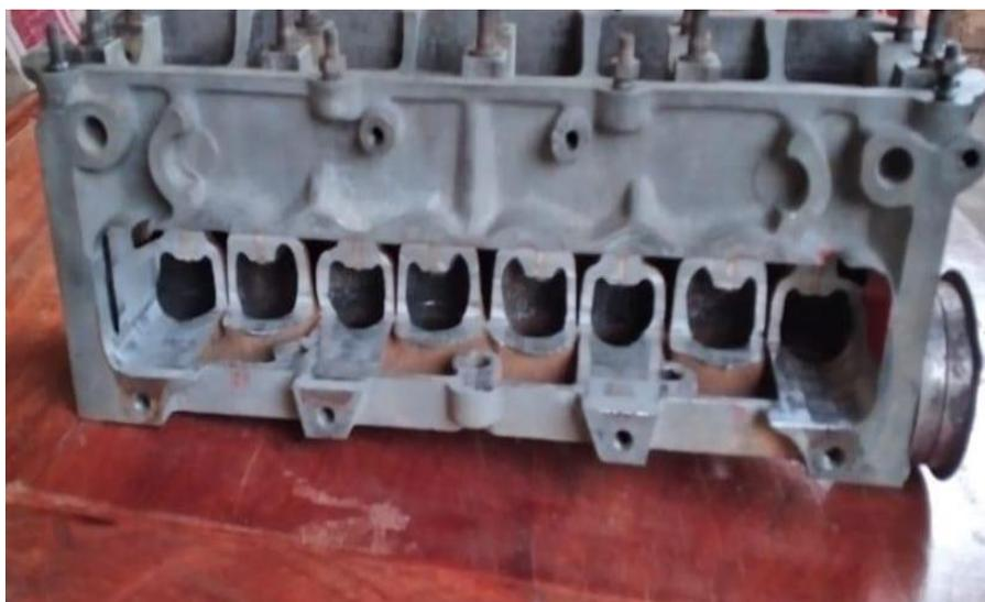
**Figura 19:** Cabeçote do motor após processo de fresagem
