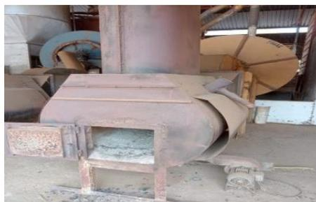
**Figura 2** – Fornalha no processo de reposição de lenha
