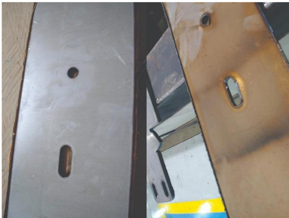
**Figura 15:** Representação visual das chapas cortadas a Laser a esquerda e a plasma a direita.
