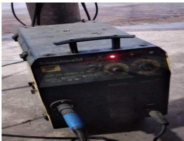
**Figura 24:** Máquina modelo smashweld 266x da marca ESAB, utilizado na soldagem para confecção da banca.
