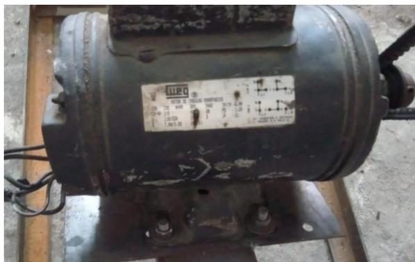
**Figura 28:** Motor elétrico utilizado para rotação do motor a combustão
