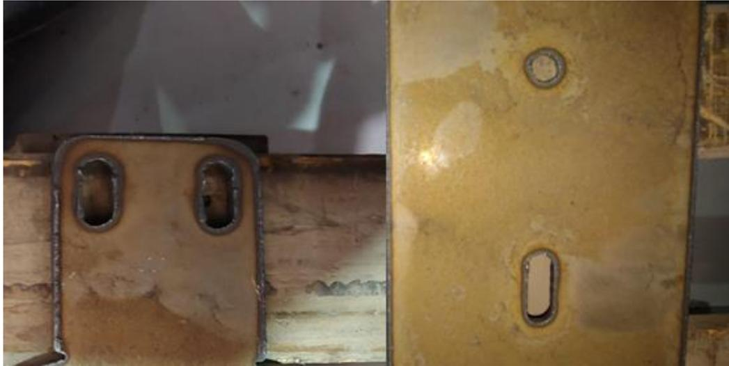
**Figura 07:** Representação visual das chapas cortadas a plasma.
