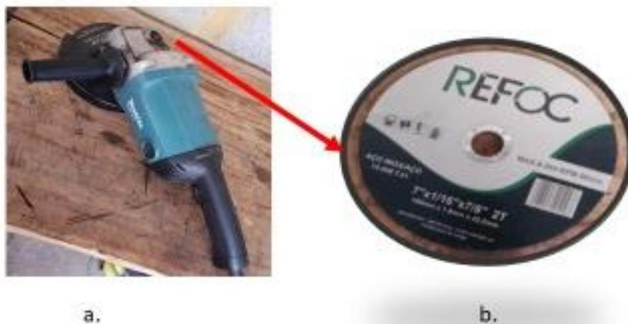
**Figura 17.a e 17.b:** Esmerilhadeira e disco utilizado para o corte
