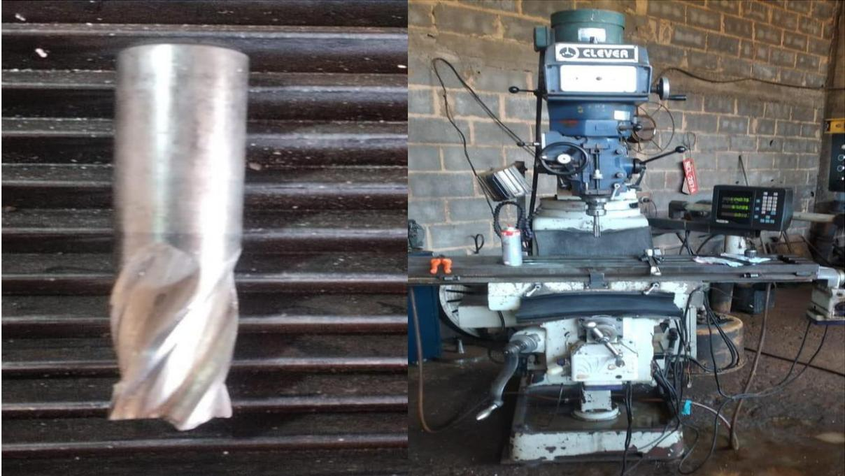
**Figura 20.a e 20.b:** Fresa de 12 mm e fresadora ferramenteira Clever 4 vs
