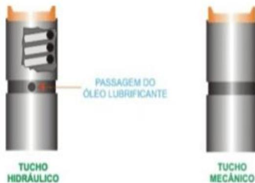
**Figura 7:** Ajustes hidráulicos (tuchos)
