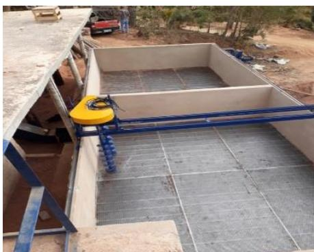
**Figura 4** – Misturador de café em montagem
