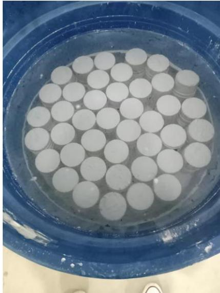
**Figura 4:** Cura dos corpos de prova
