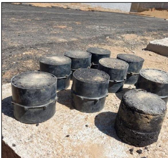
**Figura 1:** Execução da moldagem dos Corpos de Prova
