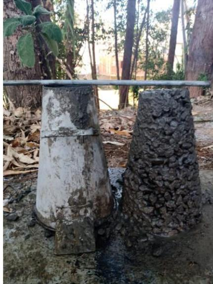
**Figura 1:** Slump test do concreto convencional
