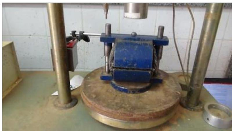
**Figura 3:** Deformação do CP após Ensaio Marshall
