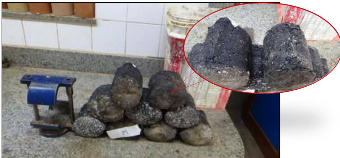
**Figura 4:** Corpos de Prova após o Ensaio Marshall
