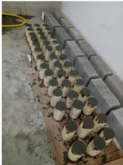
**Figura 3:** Moldagem e identificação dos corpos de prova
